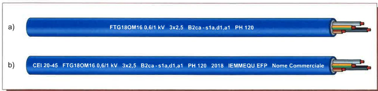
Fig. 2 - Nuovo cavo FTG18OM16 0,6/1 kV, esempio di marcatura: a) minima b) estesa.
